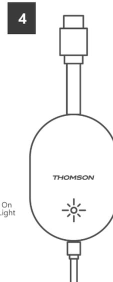
Enciende el televisor y enchufa el Streaming Dongle 150 Cast a la corriente y sigue las instrucciones en pantalla.
